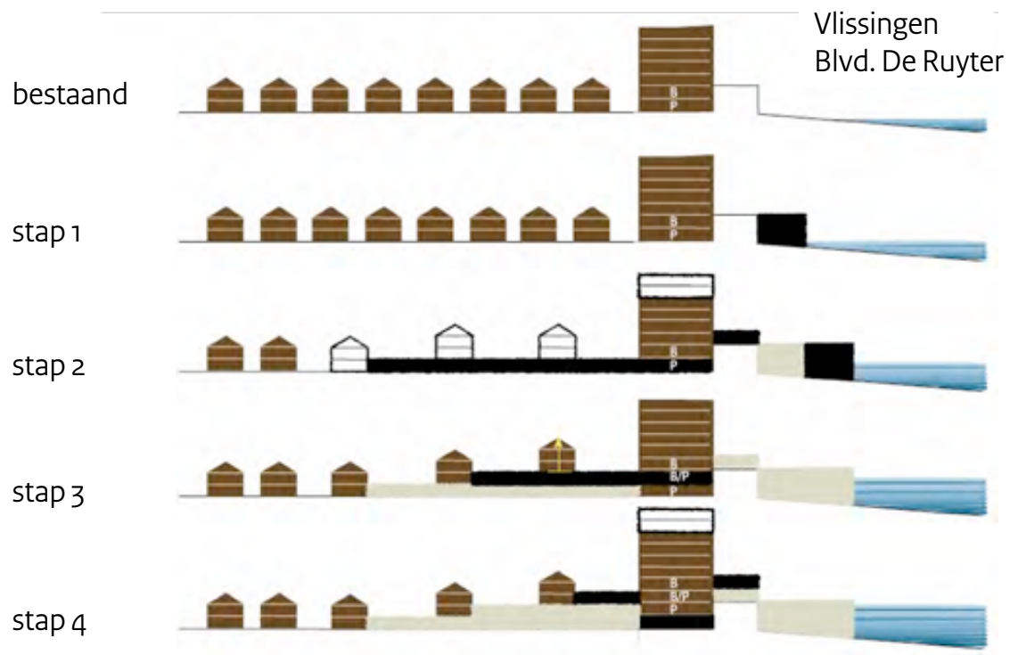
Principedoorsnede versterking waterkering in fasen voor Vlissingen (bron, Gemeente Vlissingen)
